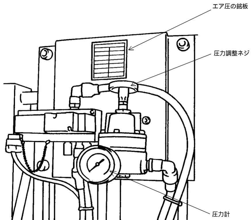
圧力の調整は、調整ネジを時計方向に回すと上昇し、反時計方向に回すと下降します。
