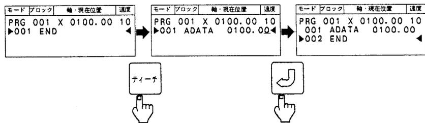
手順3 入力したADATA命令から、UNI-ROBOを適当に移動させます。その後、入力したADATA命令へカーソルを移動させ、ステップ運転を実行します。
