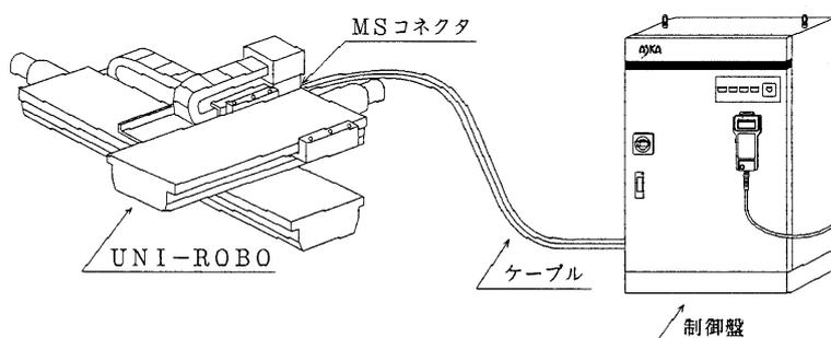
手順2 ロボット本体に制御盤からのケーブルを接続します。
