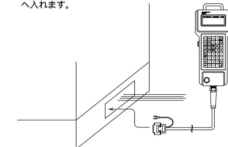
手順3 制御盤内のCPUラックのコネクタに、接続コネクタを接続します。ロックは右回しになっていますので、確実に締め付けてください。
