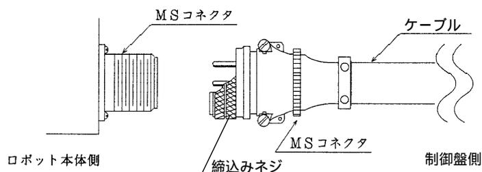
手順3 締込みネジを右に回して締めます。完全に締め込みますが、過度の締め込みはしないでください。
