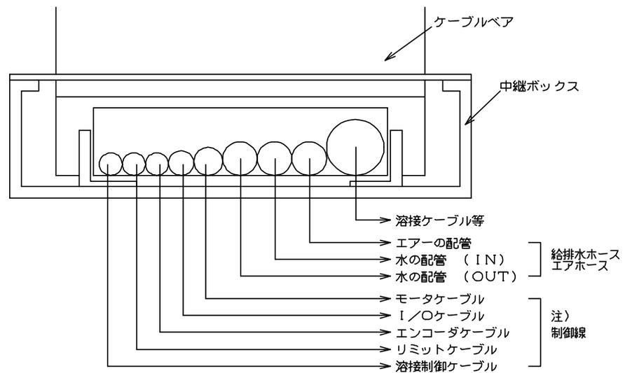
注) 溶接ケーブルと制御線はできるだけ離して整理して下さい。
