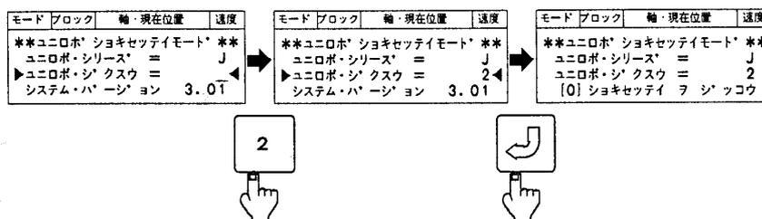
手順5 **0** キーを入力してメモリクリアを開始します。メモリ初期設定終了後、**運転準備** 押しボタンを押してください。
