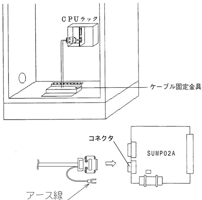
手順4 盤内の固定金具にケーブルを固定してください。
