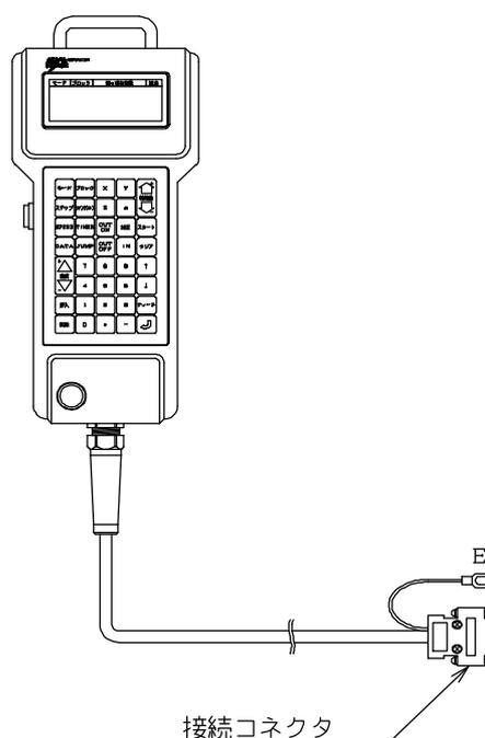
手順2 コネクタの接続をします。接続コネクタを制御盤配線穴より盤内へ入れます。
